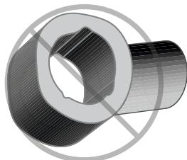
\*\* No reutilizar si esta ovalado, mutilado, corroido y/o presenta desgaste, quebraduras o daño físico\*\*
