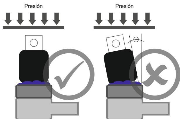
Mantener presión hasta colocar las pieza en posición correcta vertical y angular.
