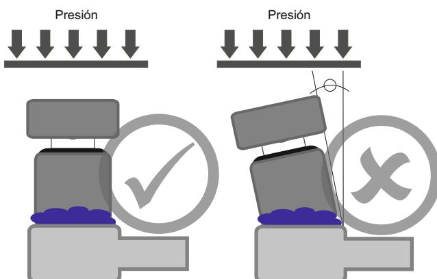
Mantener presión hasta colocar las pieza en posición correcta vertical y angular.
