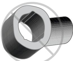
\*\* No reutilizar si esta ovalado, mutilado, corroido y/o presenta desgaste, quebraduras o daño físico\*\*
